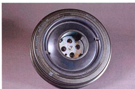
Torsie-trillingdemper met geïntegreerde ontkoppelde riemschijf voor Jaguar. (foto Provido)
